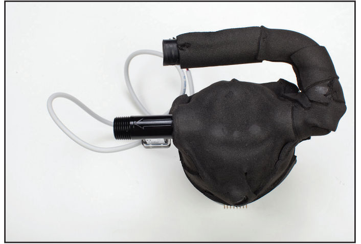
图 8-53 带指示流向箭头的流量计；方向与循环泵输出方向相同
