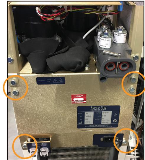
Fig. 8-36 Remova os seis parafusos (Passo 3)
