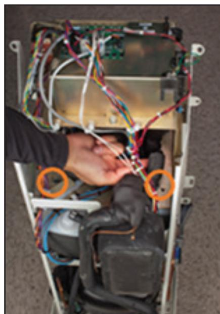
Fig. 8-17 Remova os dois parafusos (Passo 2)
