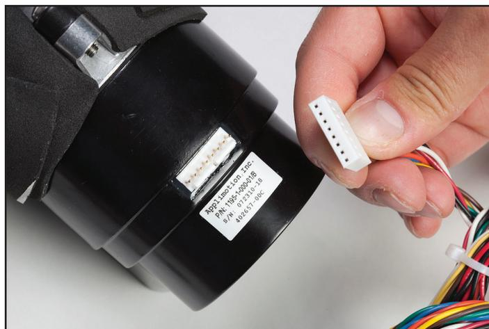
Fig. 8-32 Ilustração do conector da bomba antes de ser ligado (acima), ligado, mas encaixado incorretamente com um pino exposto (abaixo à esquerda), e encaixado corretamente (abaixo à direita)
