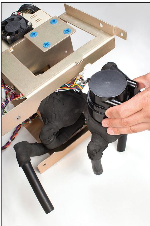
Fig. 8-31 Retire cuidadosamente a Bomba de mistura (Passo 5)
