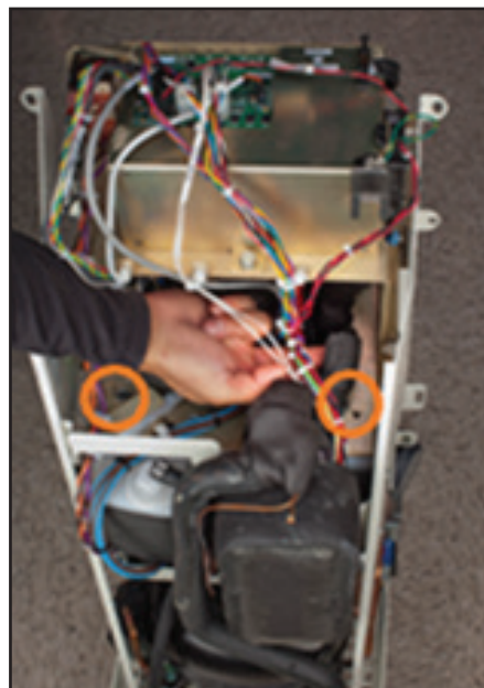
8-17. ábra Távolítsa el a két csavart (2. lépés)
