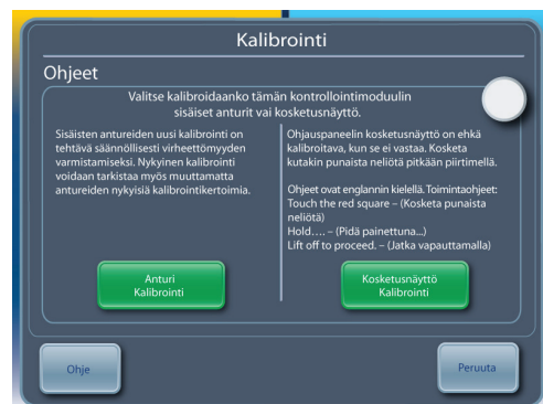
Kuva 2.1. ARCTIC SUN® -lämpötilanhallintajärjestelmän kontrollointimoduulin kalibrointinäyttö
