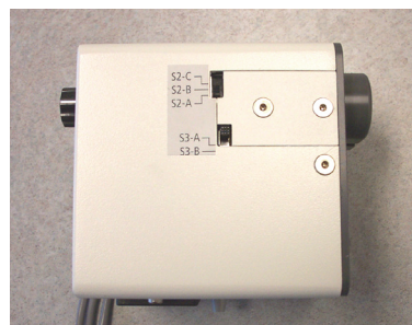
Figura 2.7. Interruptores 2 e 3 da UTC
