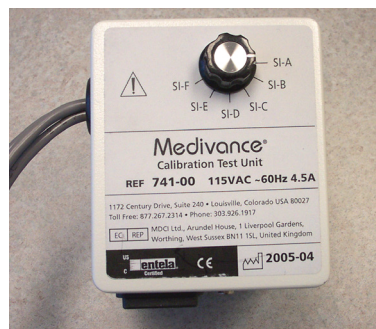
Figura 2.6. Interruptor 1 da UTC
